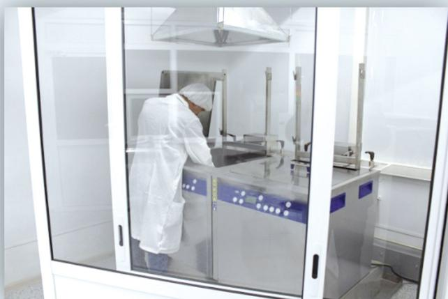
Все платы после сборок поступают на участок ультразвуковой отмытки на котором установлены ванны УЗ «ELMA Pro». Что бы исключить остатки воды используется сушильный шкаф, в котором при температуре 45-60 градусов изделия просушиваются до полного удаления влаги.
