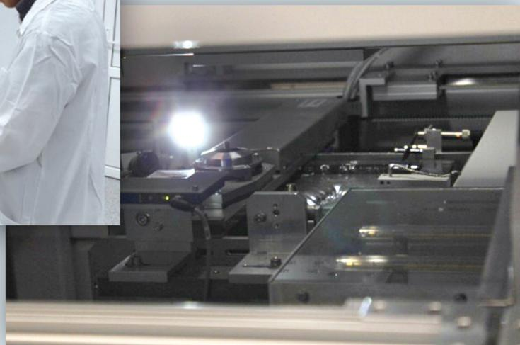
При необходимости проведения выводного монтажа на предприятие установлен комплекс волновой пайки «CUBE» который имеет очень гибкую систему настройки пайки (0- 7<sup>0</sup>) что позволяет получить пайку высокого качества.
